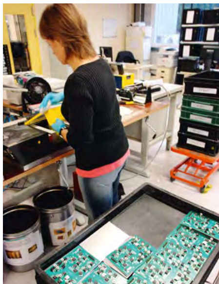
Einblicke in die GYS-Welt in Laval: Endmontage der Schweißanlage (obere Reihe, von links). Automatisches Wickeln der Spulen, Leiterplatten-Fertigung; Mitte links: Blick in die moderne Gehäuse-Fertigung, großes Bild: Kontrolle und Versiegelung der Leiterplatten erfolgt händisch, re.: Gehäuseteile kommen aus der Lackierbox; unten links: Metallbearbeitung mit modernem Trumpf-Maschinenpark, re.: gut organisierter Arbeitsplatz.
