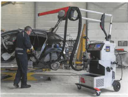
Intelligente Schweißung: Der GYSpot PTI Genius bestimmt automatisch die Art des Stahls, die Dicke der Bleche und das Vorhandensein von Klebstoff und Isoliermaterial zwischen den Blechen.
