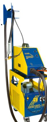
Pour profiter au maximum de ses cadences élevées, l'Easy TIG est livré avec une torche adaptable sur un chariot de refroidissement liquide.
